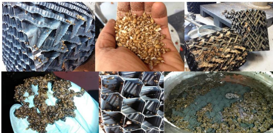
Abbildung 9. Befall des Festbettes mit Schnecken: Ein Abstellen des Zulaufes über mehrere Tage führt dazu, dass sich die Schnecken aufgrund des Sauerstoffmangels an der Oberfläche ansammeln. Auf diese Weise können sie gut entnommen werden, was jedoch nur eine vorübergehende Reduktion des Schneckenbefalls gebracht hat. Am Ende der Versuchsdauer war auf den Wabenpackungselementen kein Biofilm sichtbar, jedoch waren massenhaft Schneckenhäuser vorhanden (Quelle: Böhler et al., 2017).
