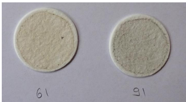
Figure 30 Préfiltres des prélèvements en entrée (61) et sortie (91) du Biofor® test du 18.04 au 19.04, dosage de 1.5 gCAP/m 3 . Analyses laboratoires : MES 61 = 8 mg/L, MES 91 = 7 mg/L
