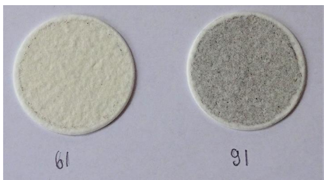
Figure 32 Préfiltres des prélèvements en entrée (61) et sortie (91) du Biofor® test du 20.03 au 21.03, dosage de 15 gCAP/m 3 . Analyses laboratoires : MES 61 = 8 mg/L, MES 91 = 8.5 mg/L
