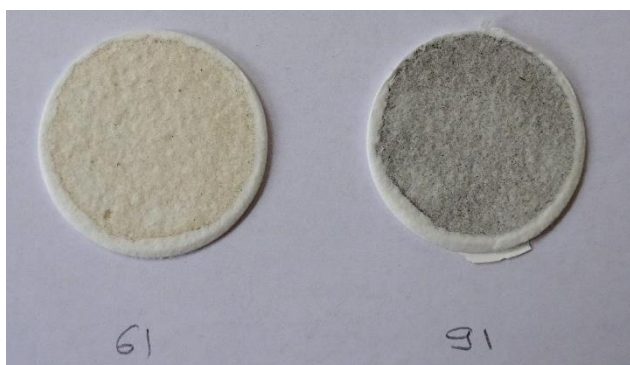
Figure 31 Préfiltres des prélèvements en entrée (61) et sortie (91) du Biofor® test du 20.04 au 21.04, dosage de 10 gCAP/m 3 . Analyses laboratoires : MES 61 = 11 mg/L, MES 91 = 11.5 mg/L
