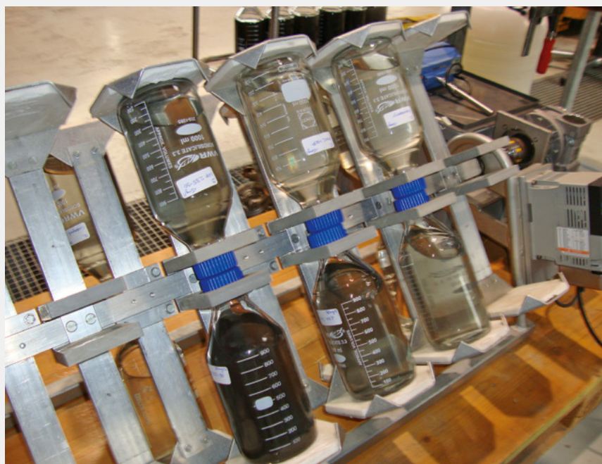
Fig. 3 Vergleich verschiedener PAK-Muster mittels Überkopf-Schüttelversuche
