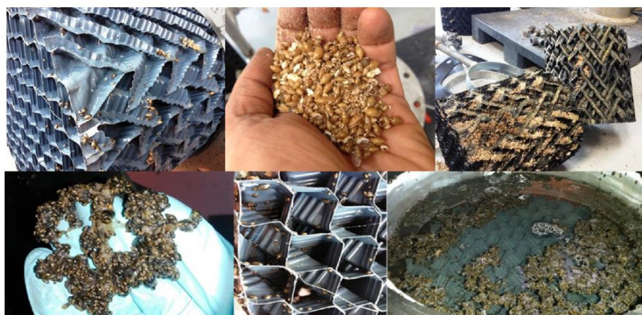
Illustration 9. Invasion du lit fixe par des mollusques. Après l'arrêt du débit entrant pendant plusieurs jours, les mollusques se sont regroupés en surface en raison du manque d'oxygène et ont pu être retirés facilement. Mais ceci n'est qu'une mesure temporaire. Après le démontage des éléments empilés, aucun biofilm n'a été détecté ; par contre, les carapaces des mollusques étaient présentes en grand nombre (source: Böhler et al., 2017).
