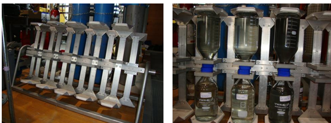
Figure 3 Agitateur rotatif de l'Eawag (à gauche). Ils permettent d'enserrer jusqu'à 22 bouteilles en verre d'un litre et de les faire tourner simultanément. Dans l'exemple (de droite), 12 bouteilles (6 par côté) sont placées dans l'agitateur. En raison du poids, il convient de veiller à placer les bouteilles de manière symétrique et identique de chaque côté. Des bouteilles de plus petite taille peuvent être utilisées en réglant le dispositif de serrage.
