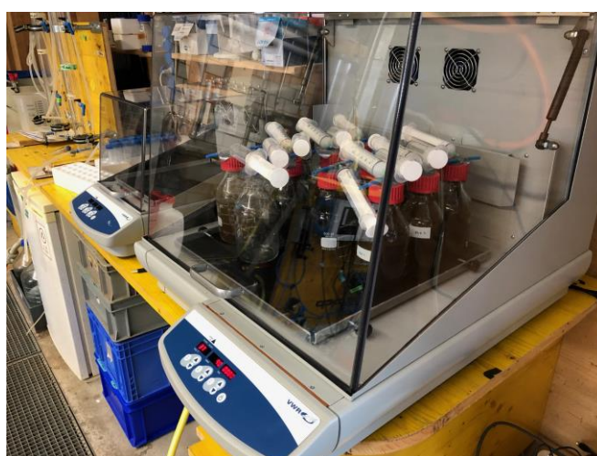
Figure 4 Agitateur horizontal de l'Eawag (petit modèle à gauche, grand modèle à droite). Ils permettent de projeter à brefs intervalles l'échantillon d'eaux usées de manière saccadée contre les parois des bouteilles de test de sorte à garantir un bon mélange et transport de substances. Chaque batch possède sa propre seringue pour le prélèvement de l'échantillon.
