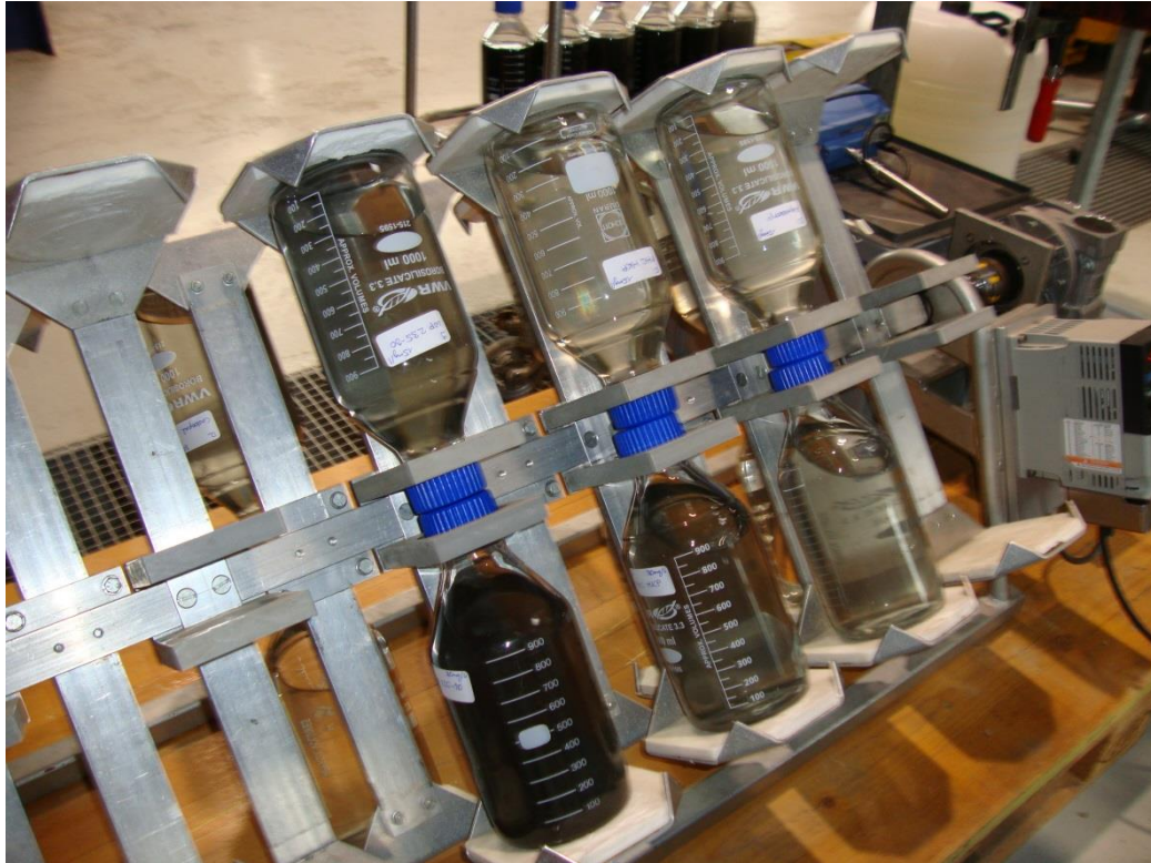
Fig. 3 Comparaison de différents échantillons de CAP à l'aide d'essais par agitation
