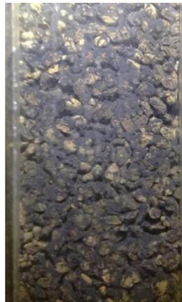
Figure 17. Dépôt de CAP dans le filtre à sable (projet Aktifilt, Löwenberg et al., 2016)
